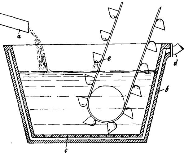
steigender Druckluft begegnet, die die zunächst an der Oberfläche schwimmenden Schlackenkumulen durchdringt und porös macht und in Gestalt lockerer und leichter Klümchen erstarrt. —
