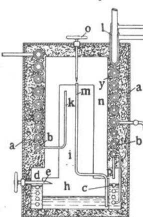
Heinrich Kriegsheim, Berlin. Verf. zur Entfernung von freier Kohlensäure, Sauerstoff und anderen Gasen aus Wasser, dadurch gekennzeichnet, daß zur Schaffung des erforderlichen niederen Partialdruckes für die auszuscheidenden Gase und zur Oxydation etwa im Wasser vorhandener oxydierbarer Verbindungen Luft in entsprechender Menge bei solchem Unterdruck durch das Wasser hindurchgeleitet wird, daß die in Lösung gehende Sauerstoffmenge die unschädliche Menge nicht übersteigt. —
